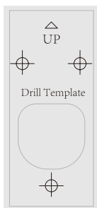
Sisetelefoni paneeli puurimisšabloon (1 tk)
